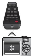
p. ej.) Con una cámara digital: Apunte la cámara digital hacia el diodo infrarrojo del control remoto en el frente del control remoto. Presione y sostenga cualquier tecla sobre el control remoto y vea en la pantalla de la cámara. Si la luz infrarroja pulsátil aparece en la cámara, el mando a distancia está emitiendo una señal IR.
