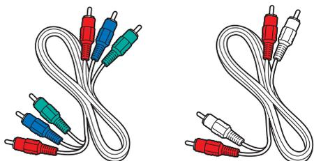
Prend en charge les signaux analogiques de haute définition, mais la qualité de l'image est inférieure à celle offerte par la norme HDMI. Les composants des câbles vidéo (Y/Pb/Pr) combinent des câbles vidéos rouges, verts, bleus avec des câbles audio (G/D) rouges, blancs. Faites correspondre la couleur des câbles à celle des connecteurs du téléviseur.
