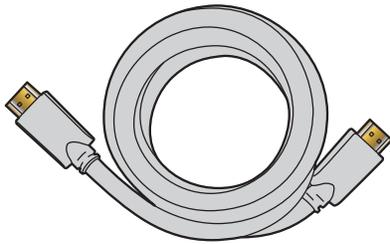
Soporta señales Digitales de alta definición y proporciona la mayor calidad de imagen y sonido. Las señales de vídeo y de audio se combinan en un cable. Debe usar HDMI para vídeo de alta definición completa y activar HDMI-CEC.
